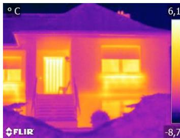
La thermographie permet de visualiser les températures de surface de matériaux à l'aide d'une caméra infrarouge, ce qui permet de créer une image facilitant l'interprétation, on
